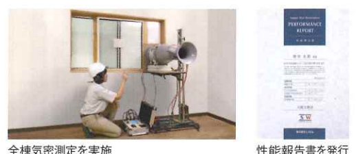
全棟気密測定を実施
